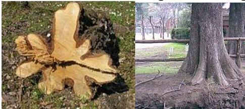
67. Дайте определение резкому местному утолщению ствола различной формы и размеров, сопровождающееся свилеватостью древесины, которая высоко ценится в качестве отделочного материала мелких художественных и бытовых изделий
