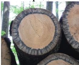
98. Дайте определение красновато-коричневой или бурой окраске подкорковых слоев сплавной древесины тех пород, кора которых богата дубильными веществами
